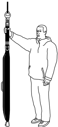
Vorbereitung für die offene Rettungsschlinge
