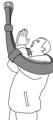
Einstieg bei geschlossener Rettungsschlinge
