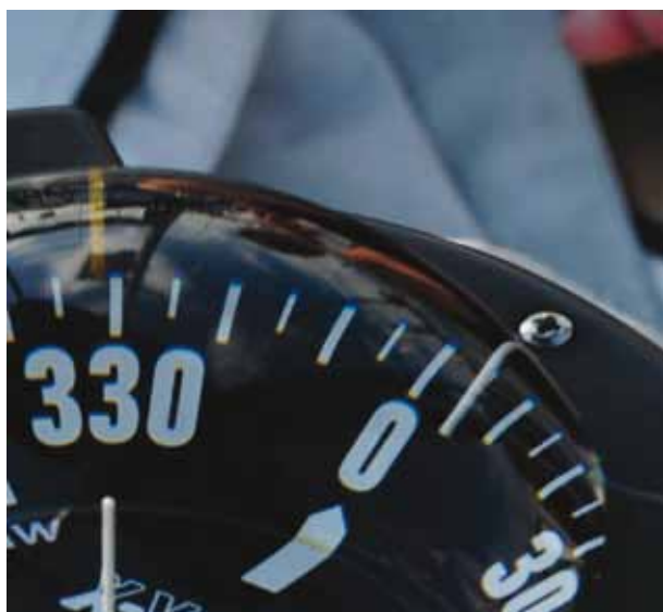
Als Steuerkompass geeigneter Magnetkompass
